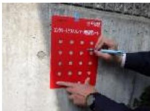
コンクリートテストハンマー測定箇所シートを使い、測定点位置をチェックします。チョークがあれば位置を落としやすいです。
