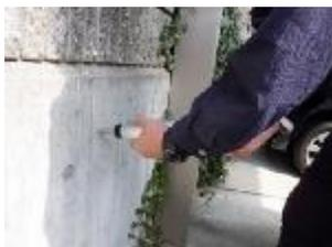
先ほどチェックした測定位置に水平に機器を当て押し込みます。
